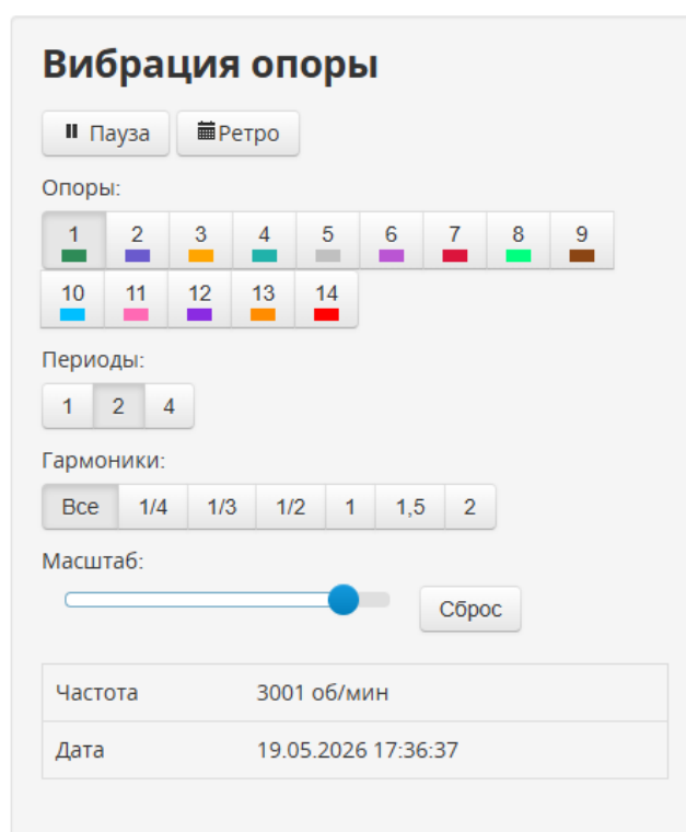
Рис. 73 – Боковая панель анализа вибрации опор
