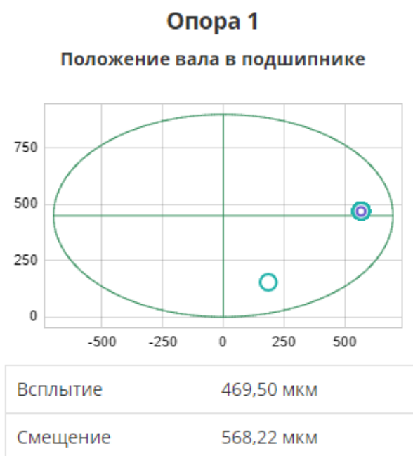
Рис. 79 – Пример графика положения вала в подшипнике
