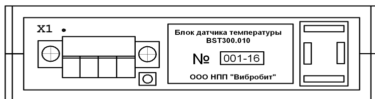
Рисунок 28 – Внешний вид блока датчика температуры BST300.010
